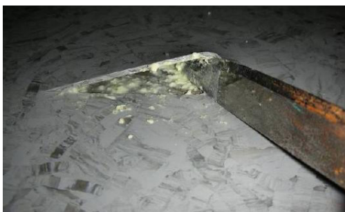
FIGUR 8. Alkalisk hydrolysis av lim (Keinänen, 2013).
