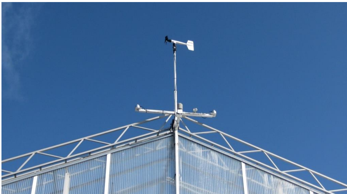
Figur 6 Väderstation med sensorer för vindhastighet och riktning (överst), globalinstrålning, temperatur och fuktighet samt FIR-strålning (nedre tvärbommen)
