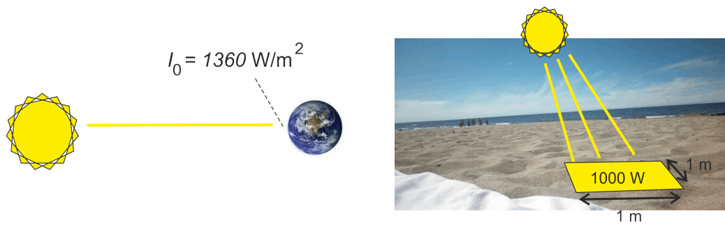
Figur 1. Den intensitet som faller in på en yta ovanför atmosfären och vinkelrätt mot solstrålarna anges av den så kallade solarkonstanten I_0 . Solstrålningen som når en 1 m x 1 m stor yta på marken en solig sommardag motsvarar cirka 1000 W.
